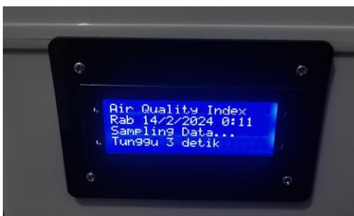
Gambar 8. Tampilan LCD untuk sampling data 3 detik
