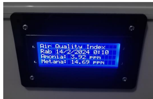
Gambar 9. Tampilan LCD untuk pembacaan ammonia dan metana
